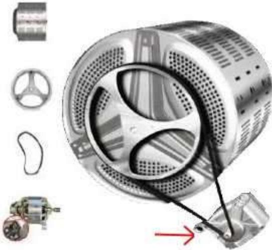
Dans les machines à laver récentes, une **carte électronique associée à un onduleur permet de piloter dans les 4 quadrants la rotation du tambour** en fonction de multiples paramètres (poids du linge, quantité d'eau, programme choisi...). Le moteur utilisé est un asynchrone.
