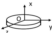
Déterminer l’opérateur d’inertie du disque de frein assimilé à un disque de centre  $O$ , de rayon  $r$ , d’épaisseur négligeable, de masse  $m$ , homogène, en son centre d’inertie.
