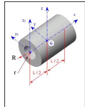
1- Déterminer la matrice d'inertie du cylindre de révolution 1, au point G, dans la base  $(\vec{x}, \vec{y}, \vec{z})$ .
