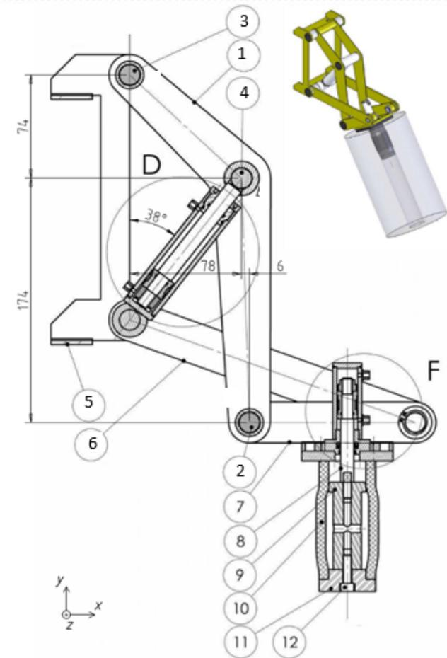
On donne :  $\vec{C}(4 \rightarrow 1) = -4900 \vec{y}$ , déterminer les actions mécaniques en B et D aux appuis
