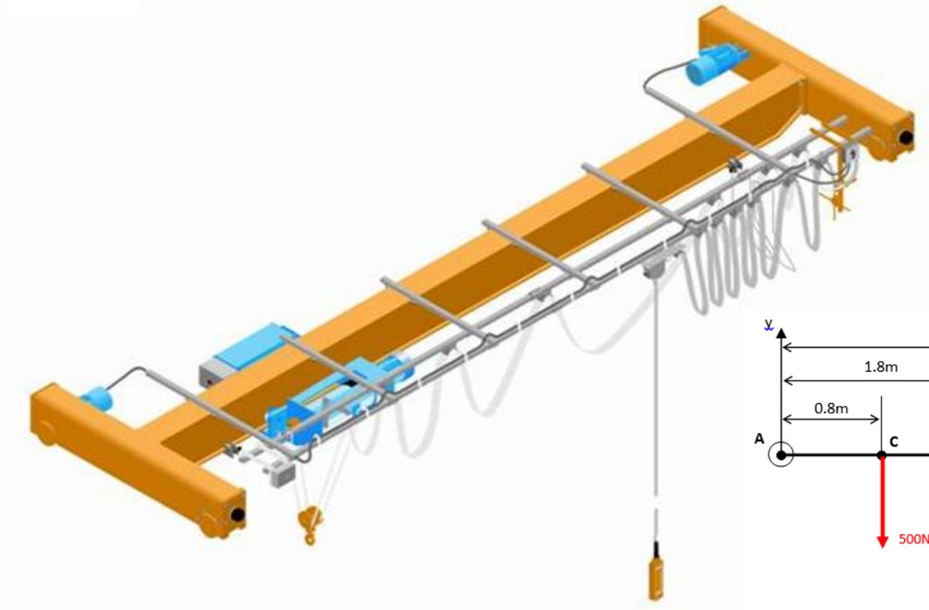
Notre étude s'intéresse à la flexion de la **poutre 1** "pont", dans le cas d'un chargement statique modélisé par le schéma ci après. Le plan  $(A, x, y)$  est un plan de symétrie pour la poutre et pour les charges qui lui sont appliquées.
