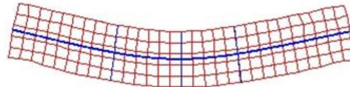
Figure 6 : Déformée amplifiée de la poutre avec la ligne moyenne et les sections droites
