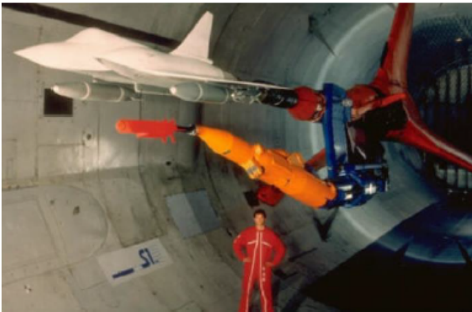
Photos 1 et 2 : Installation de trajectographie captive
