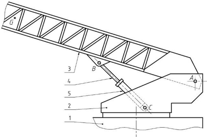
L'échelle de pompier présentée ci-contre est montée grâce à un vérin double effet. Sur le camion, une pompe et un compresseur fournissent une pression d'alimentation hydraulique de 80 bars. Le CDC impose un effort de poussée du vérin mini de 65000N.
